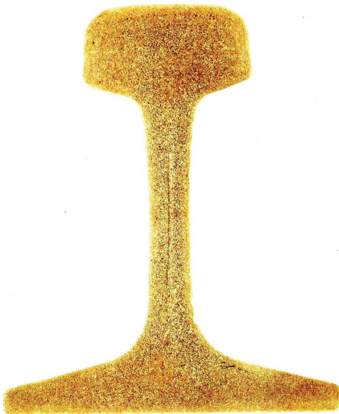
Рисунок И.13 — Ликвационные полосы (серный отпечаток)
